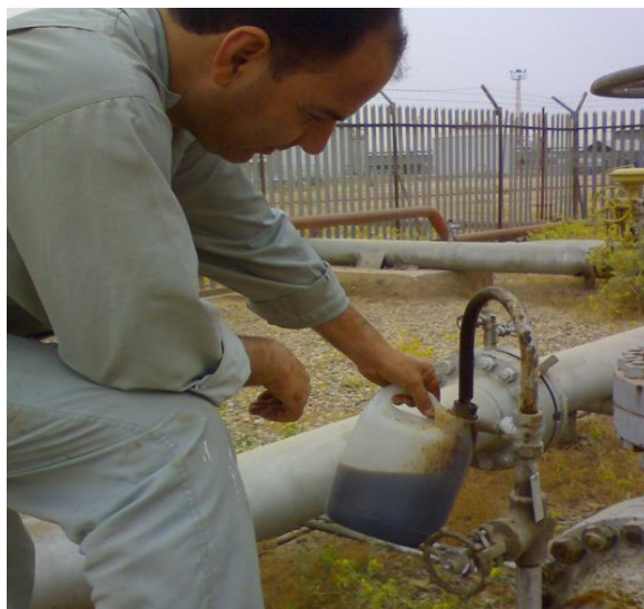
شکل 4 نمونه گیری از نفت خام واحد مارون 4
