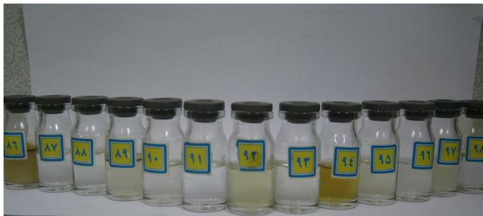
شکل 6 فازهای آبی استخراج شده از نمونه های نفت خام
